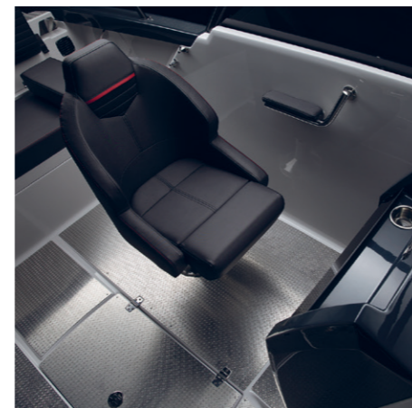
OFF-SHORE ISTUIMET • mahdollisuus muuttaa ajoasentoa • pituussäätö • kaasutoiminen korkeussäätö ja jousto
